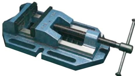
DOUBLE GUIDAGE DU MORS MOBILE. MORS EN ACIER TREMPÉ RECTIFIÉ. FIXATION LATÉRALE ET FRONTALE. SEMELLE FRAISÉE. MORS RÉVERSIBLE : MÂCHOIRE FIXE : 1 FACE RAINURÉE EN V VERTICALE ET HORIZONTAL POUR TUBE - 1 FACE STRIÉE. MÂCHOIRE MOBILE : 1 FACE LISSE - 1 FACE STRIÉE. DOUBLE GUIDAGE DU MORS MOBILE SUR LES FACES FRAISÉES. VIS ROULÉE MONOBLOC.
