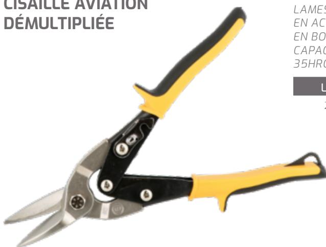
LAMES EN ACIER FORGÉ. TAILLANT AVEC MICRO DENTURE. POIGNÉE EN ACIER GAINÉE ABS ET ÉLASTOMÈRE ADHÉRENT. BUTÉE D'APPUI EN BOUT DE MANCHE. VERROUILLAGE PAR FERMOIR À ENCOCHE. CAPACITÉ DE COUPE : CUIVRE = 1,5 MM. ACIER DOUX = 1,2 MM. ACIER 35HRC = 0,8 MM. INOX 304 = 0,7 MM
