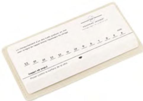
PERMET DE MESURER L'ÉPAISSEUR DES VITRAGES EN LECTURE DIRECTE ET L'ESPACE D'AIR ENTRE LES 2 VITRAGES.
