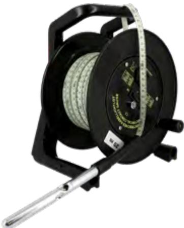
MESURE LA DISTANCE SOL-EAU DANS UN PUITS. RUBAN EN POLYAMIDE JAUNE LARGEUR 13 MM, ÂME EN ACIER TREMPÉ. UN DOUBLE FIL EN CUIVRE TRANSMET LES INFORMATIONS SOUS FORME LUMINEUSE OU SONORE. SONDE EN ACIER Ø 15 MM. BATTERIE 9 V.
