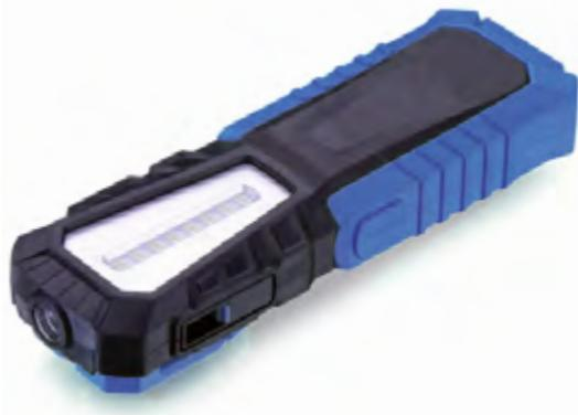
BALADEUSE À LEDS. BOÎTIER ENTIÈREMENT CAOUTCHOUCÉ. PIVOTE À 90° SUR SA BASE MAGNÉTIQUE. 3 NIVEAUX D'INTENSITÉ LUMINEUSE : 240, 70 ET TÊTE 45 LUMEN. BATTERIE 2200 MAH. AUTONOMIE 6 HEURES MAX. RECHARGE PAR CÂBLE USB FOURNI.
